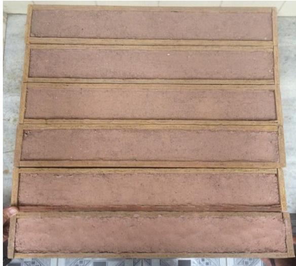
Figura 7 - Ensaio de Retração Finalizado
