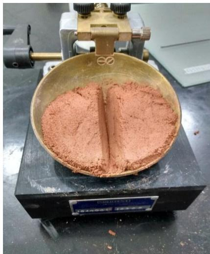
Figura 2 - Teste Limite de Liquidez
