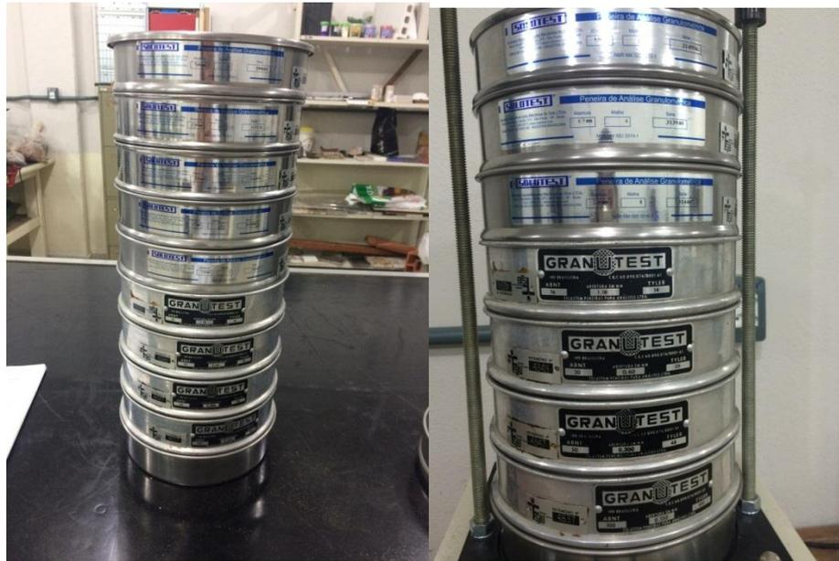
Figura 1 – Teste Análise Granulométrica
