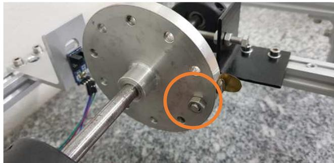
Deslocando-se horizontalmente o segundo mancal em 2 mm (Figura 3) provocou-se uma diferença angular entre os mancais. Procedimento semelhante adotado por Leite (2012), e Lima (2013).
