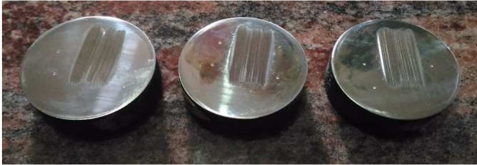
Figura 8 – Grupo 2 dos corpos de prova com tratamento térmico de têmpera sem utilização do invólucro de aço inoxidável 304
