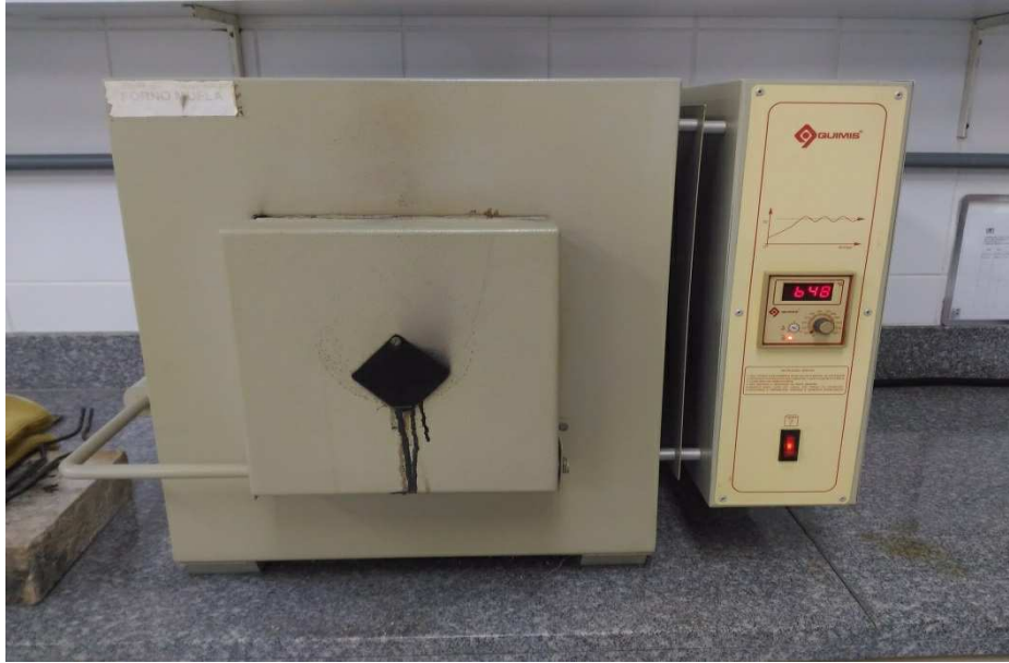
Figura 2 – Forno tipo mufla utilizado para têmpera
