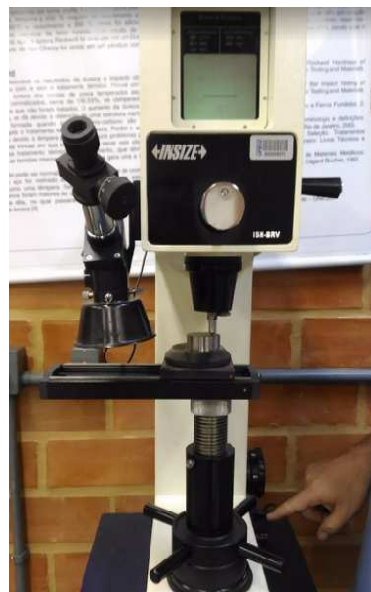
Figura 4 – Durômetro utilizado para ensaio de Dureza Rockwell C
