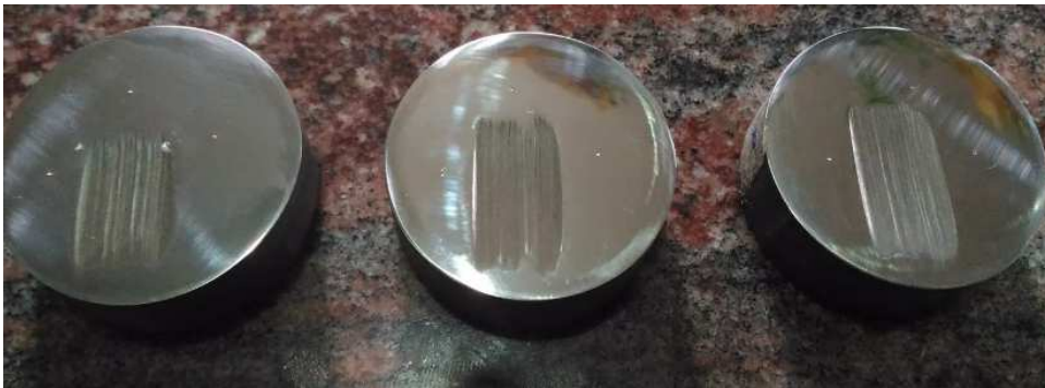
Figura 9 – Grupo 3 dos corpos de prova com tratamento térmico de têmpera e com a utilização do invólucro de aço inoxidável 304
