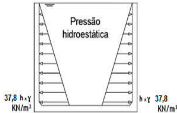
Figura 14 - Pressão Hidrostática no tanque do reservatório, vista lateral.
