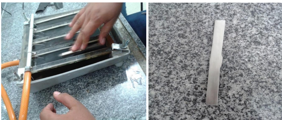
Figura 07 – Lixamento, polimento e ataque das amostras Fonte: Arquivo pessoal, 2018.
