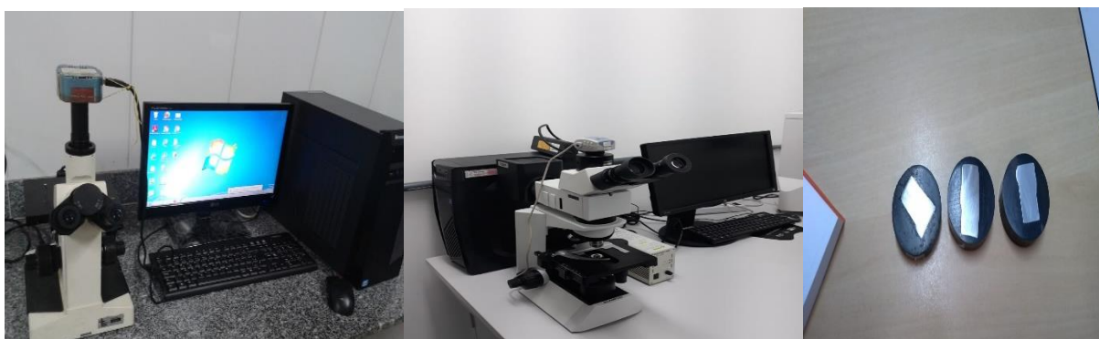
Figura 08 - Microscópio Óptico FAACZ, Microscópio Olympus, Corpos de prova Baquelite Fonte: Os Autores 2018
