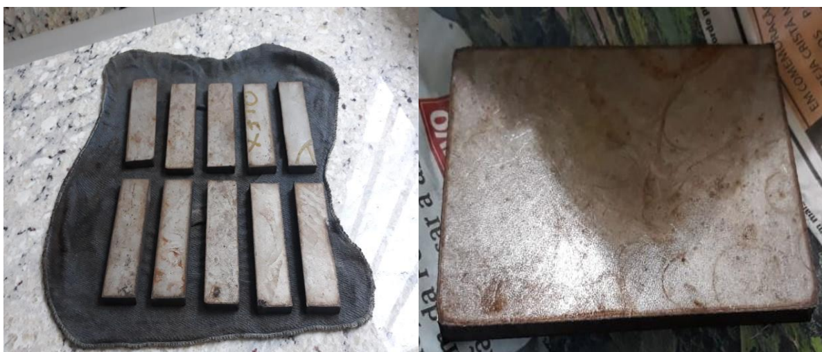
Figura 02 - Aço Duplex SAF 2205 já cortados Fonte: Arquivo pessoal, 2018.
