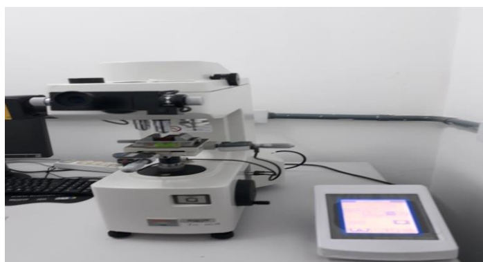
Figura 11 – Mitutoyo – Hardeness Testing Machine -HM – Máquina para realização de microdureza Fonte: Os Autores 2018
