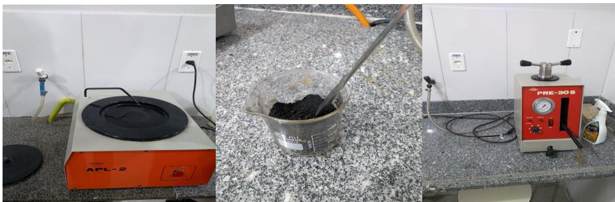
Figura 09 – Lixadeira Arotec APL – 2, Baquelite para preparação de corpos de prova e embutidora PRE – 30 S, respectivamente. Fonte: Os Autores 2018
