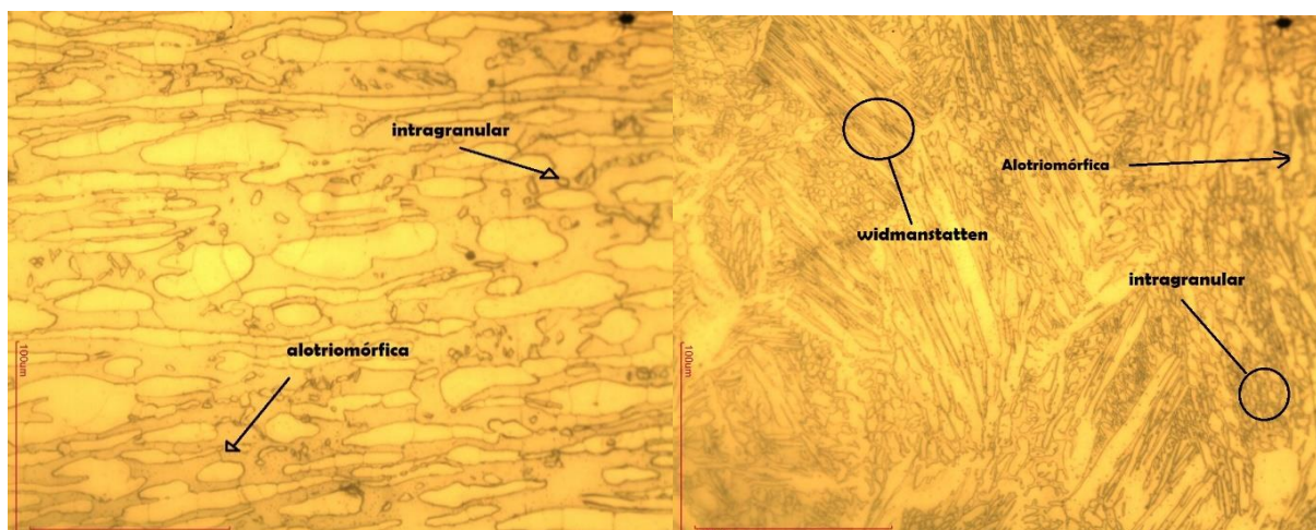
Figura 16 – Corpo de Prova C3, ZTA e ZF imagens micrográficas das estruturas ocorrência de austenita intragranular, alotriomórfica e widmanstätten Fonte: Os Autores 2018
