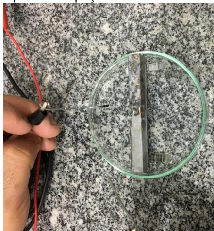
Figura 9 – Ataque eletroquímico aplicado às peças em estudo.
