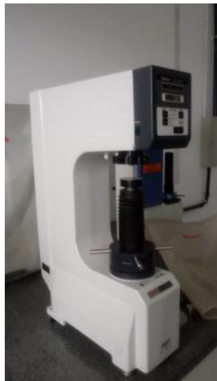
Figura 12 – Penetrador utilizado para ensaio de dureza
