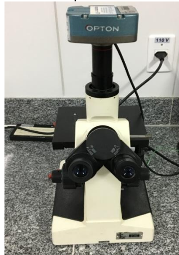
Figura 10 – Microscópio metalográfico utilizado para análise microestrutural
