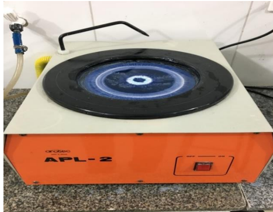
Figura 8 – Máquina Politriz utilizada para polimento e limpeza de peças cortadas.
