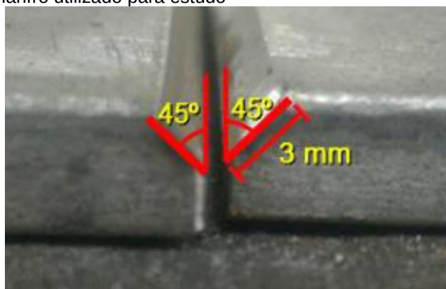
Figura 5 – Modelo de chanfro utilizado para estudo
