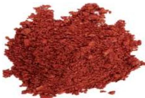
**Figura 11** - Biocoagulante obtido a partir da casca do coco verde. Fonte: Arquivo pessoal, 2019.
