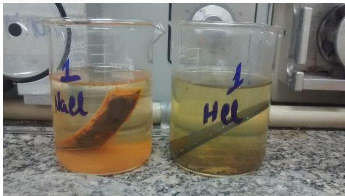
Figura 13 - Cupons de aço carbono no ensaio de imersão em meio salino (NaCl 3,5%) e ácido (HCl 0,5%) após 7 dias de imersão.
