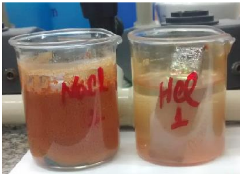
Figura 14 - Cupons de aço carbono no ensaio de imersão em meio salino (NaCl 3,5%) e ácido (HCl 0,5%) após 14 dias de imersão.
