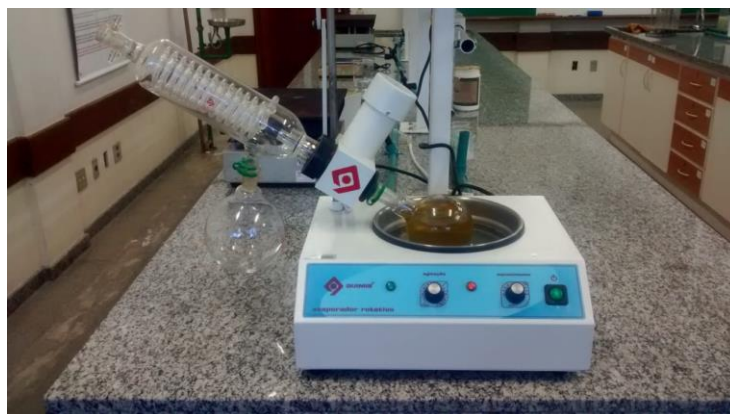
Figura 8 - Remoção do álcool da mistura do processo de saponificação do óleo de rícino
