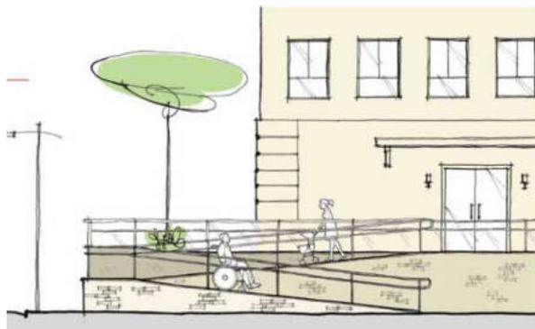
Figura 5: acesso seguro a um edifício, através de rampas com corrimão e guarda-corpo. Fonte: Cartilha Desenho Universal HIS, 2010
