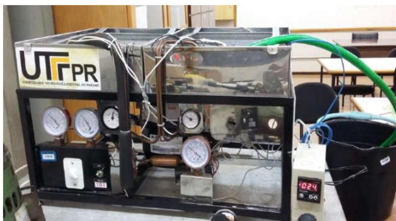
Figura 6 - Bancada didática portátil de refrigeração. Fonte (GERONIMO, 2017).
