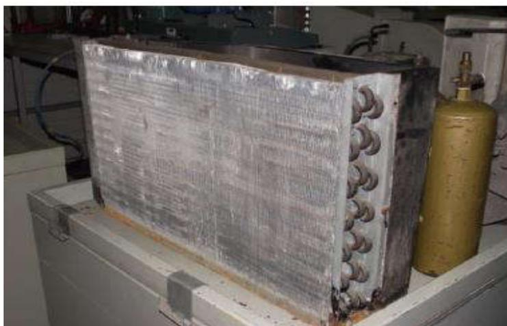
Figura 3-Condensador da bancada experimental da UFES – Fonte (CUZZUOL, 2014).
