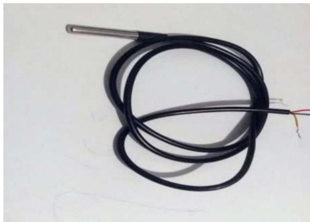
Figura 9 - Sensor de temperatura Ds18b20- Fonte do autor (2020).
