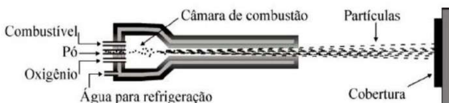
Figura 10 - Esquema de uma tocha de aspersão oxicombustível de alta velocidade
