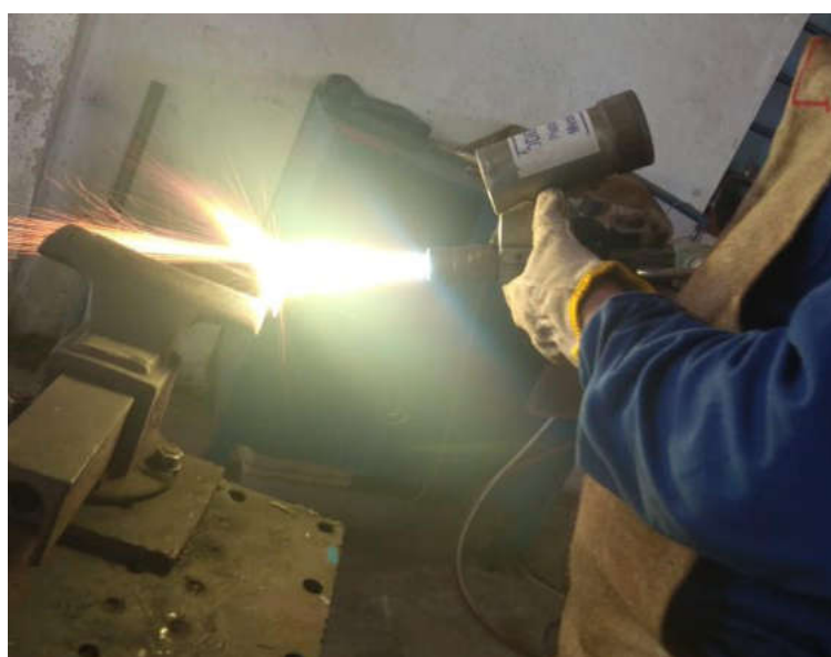
Figura 18 - Processo de aplicação da aspersão térmica
