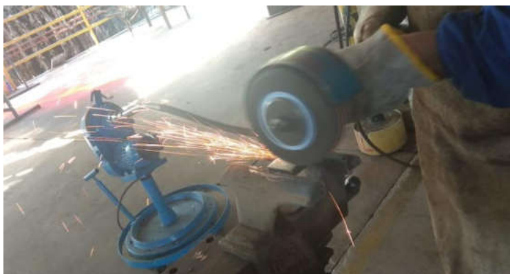
Figura 16 - Processo de acabamento superficial do corpo de prova
